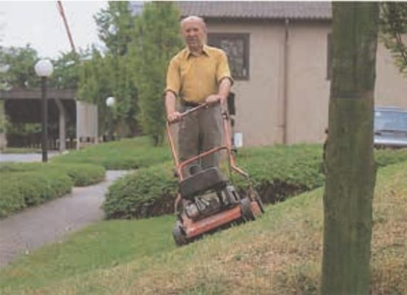
Ohne die notwendigen Schutzeinrichtungen – zum Beispiel Prallblech oder Grasfangeinrichtungen – darf nicht gemäht werden. Es besteht sonst die Gefahr, dass Sie oder andere durch hochgeschleuderte Steine verletzt werden.
