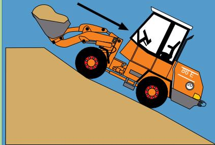
In starkem Gefälle und in Steigungen muss zur Erhöhung der Standsicherheit die Last möglichst bergseitig geführt werden.
