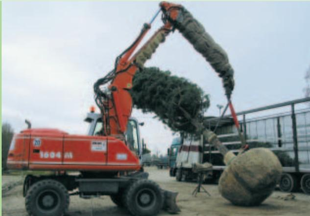
Als Hebezeugeinsatz werden das Heben, Transportieren und Ablassen von Lasten mit Hilfe eines Anschlagmittels (Seil, Kette, Hebegurt) bezeichnet. Dabei kommen Lastaufnahmemittel wie z.B. Palettengabeln, Vakuumsaugheber und dergleichen zum Einsatz. Der Maschinenführer führt die Lasten möglichst nahe über dem Boden. Durch geeignete Anschlagmethoden wird das Pendeln der Last vermieden. Der Fahrweg muss möglichst eben sein.
