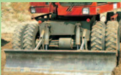
Hydraulikbagger sind in der Regel mit einem Planierschild ausgerüstet. Dieses ist vor Beginn der Baggerarbeiten abzusenken und führt so zu einer Verbesserung der Standsicherheit.
