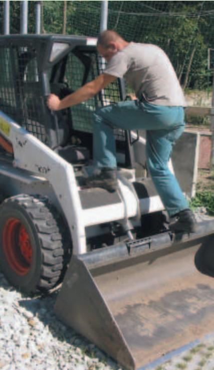
Viele Kompaktlader sind so gebaut, dass der Einstieg von vorn über die Ladeschaufel zum Fahrersitz erfolgt. Das Verlassen der Maschine bei angehobener Arbeitseinrichtung ist verboten!
