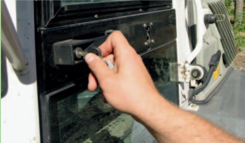
Entfernt sich der Fahrer von seiner Maschine, hat er vorher den Motor abzustellen und den Zündschlüssel abziehen.
