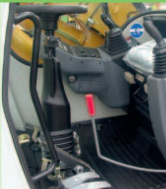
Bei Hydraulikbaggern kann der Fahrerplatz erst verlassen werden, wenn ein Sicherheitshebel oder eine Sicherheitsarmlehne an der Ausstiegsseite hochgeklappt wird. Dadurch sind die Stellteile außer Betrieb.
