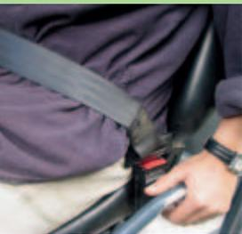
Beim Umkippen der Maschine soll der Sicherheitsgurt den Bediener im Sitz festhalten. Es ereignen sich immer wieder tödliche Unfälle, weil der Fahrer nicht angeschnallt ist, aus der Kabine herausgeschleudert und von der umstürzenden Erdbaumaschine erschlagen wird. Der Gurt soll auch das Abspringen aus der umfallenden Maschine verhindern. Die Maschine darf nur vom Fahrerplatz aus gestartet und bedient werden.
