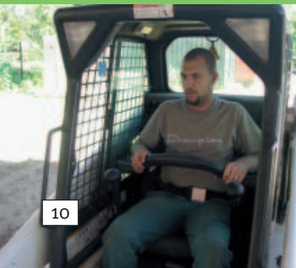
Vor der Inbetriebnahme der Maschine sind Fahrersitz und Spiegel so einzustellen, dass ein ergonomisches und sicheres Arbeiten möglich ist. Der Fahrersitz wird auf das Fahrergewicht eingestellt. So werden Vibrationen reduziert und die Wirbelsäule entlastet.
