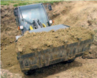
Jeder Fahrer muss wissen, dass die Last am Hang bergseitig und so nah wie möglich über den Boden zu führen ist.
