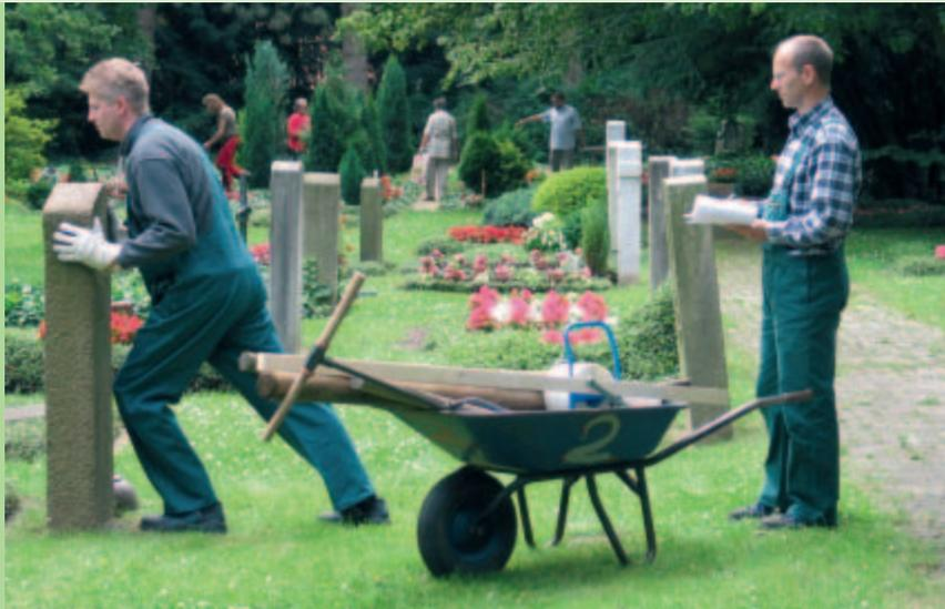
Die Überprüfung ist von **fachkundigen Personen** nach der Frostperiode im Frühjahr durchzuführen. Die Fachkunde kann nach derzeitigem Stand von einem Steinmetz vermittelt werden. Über eine Pressemitteilung oder Aushang, sollte(n) der/die Prüftermin(e) bekannt gegeben werden.
