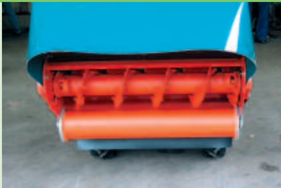
Mulchmäher mit speziellem Mähwerkzeug und Schutz Tuch
