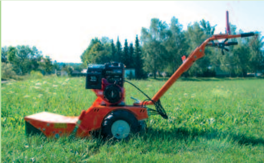
Mulchmäher mit speziellem Mähwerkzeug und Schutz Tuch
