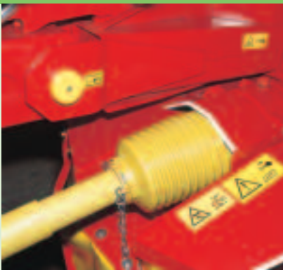
Gelenkwellen- schutz mit Sicherungskette
