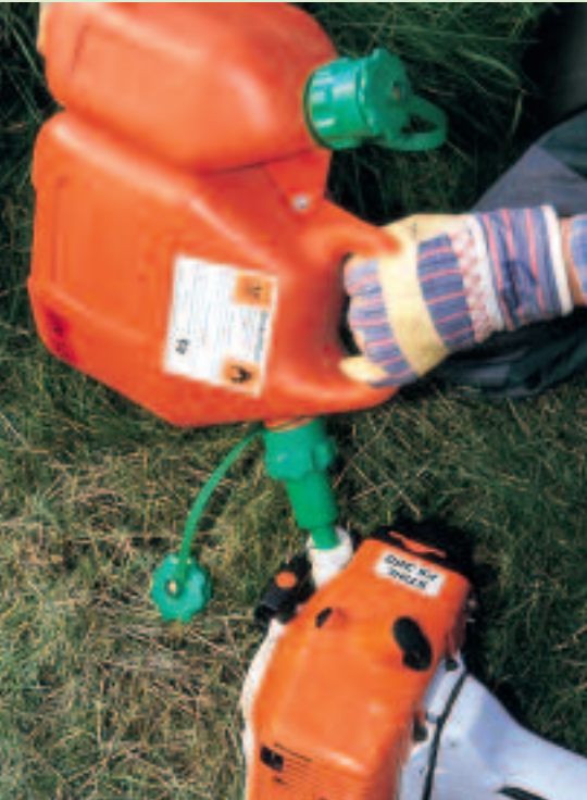
Kraftstoffkanister mit Sicherheits- einfüllstutzen
