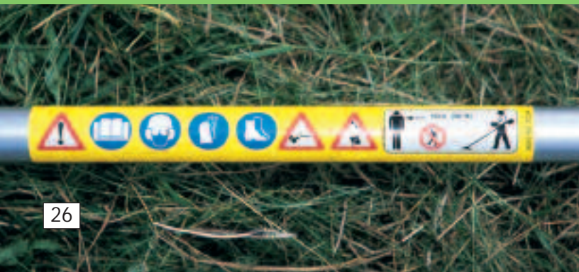
Sicherheitskennzeichnung eines Freischneiders
